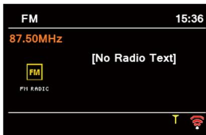
3. Für den **manuellen Suchlauf**, drehen Sie **SCROLL** im Uhrzeigersinn (aufsteigender Frequenz) oder entgegen dem Uhrzeigersinn (abnehmender Frequenz), um die Frequenz um 0,05 MHz pro Schritt zu ändern.
